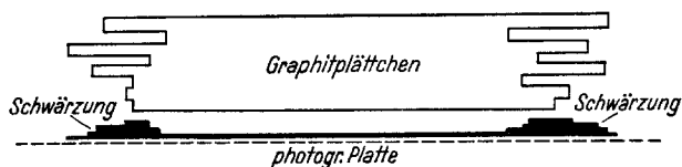
Abb. 6. Mögliche Randausbildung von Graphitflocken.
